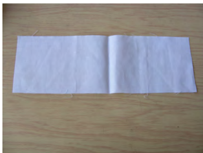
Fig. 86 - Tesatura din bumbac 100%, acoperita cu oxid de zinc
