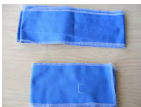
Fig. 88 - Tesatura din amestec de poliester-bumbac, acoperita cu oxid de zinc
